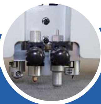
Serrilha/Picote, Meio Corte, Corte Total e Vinco.
